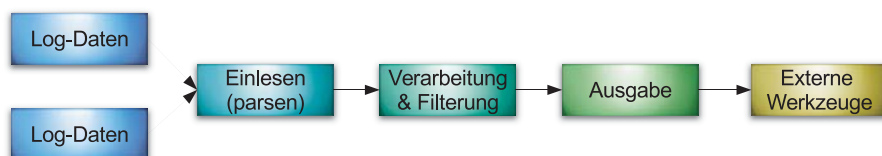
Bild 1: Die Werkzeuge zum Log-Management sind modular aufgebaut und verarbeiten die eingehenden Daten in mehreren Stufen beziehungsweise Schritten.
