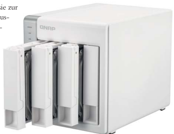
Wie bei NAS-Geräten üblich, lassen sich die Festplatten auch beim QNAP TS-431+ im laufenden Betrieb wechseln.
